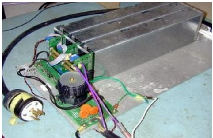
48 Volt 120 Amp Power Supply
